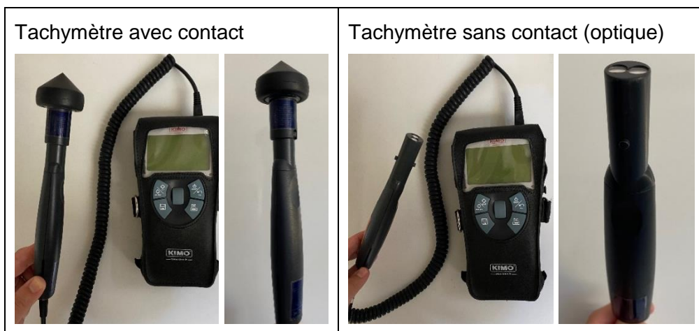
Figure 14 : Exemples de tachymètres utilisables pour mesurer la vitesse de rotation
